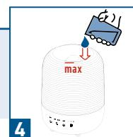
Vorsichtig Wasser einfüllen – kalkfreies/distilliertes Wasser verwenden!
